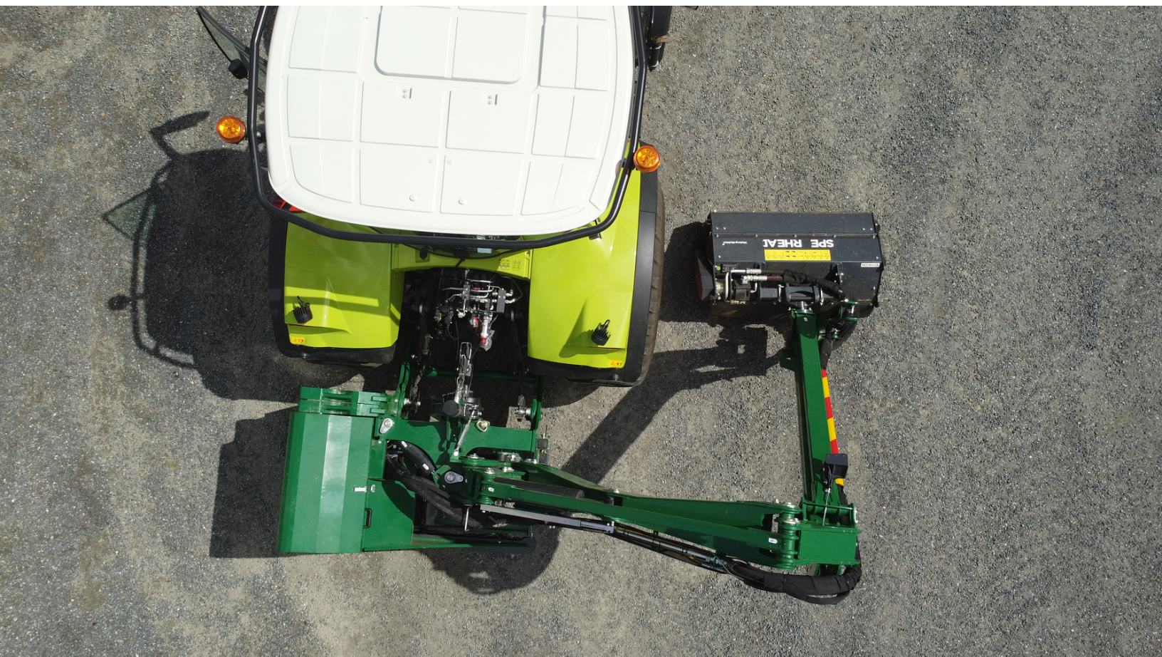
NY Spearhead armklipper TWIGA PRO monteret på en CLAAS traktor
